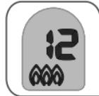
**4** Коли сковорінка досягне температури варіння, таймер дзвінить і починає відлік часу (цифри блимають).
