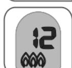
**4** След като тенджерата под налягане достигне температурата за готвене, таймерът издава звуков сигнал и започва да отчита времето (цифрите мигат).
